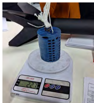
ХЭМЖИЛТ » НББУ-ийн үеэр Кансатын массыг шалгаж байна
