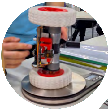
ХЭМЖИЛТ » НББУ-ийн үеэр Буцагчийн массыг шалгаж байна
