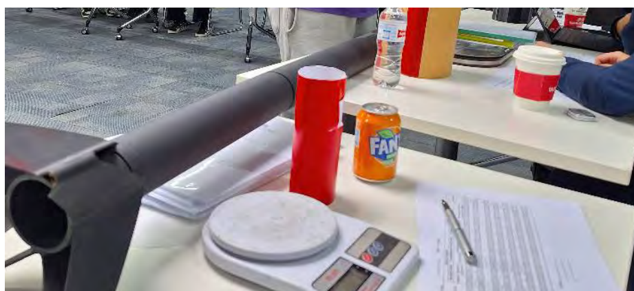
ХЭМЖИЛТ » НББУ-ийн үеэр Кансатын массыг шалгаж байна
